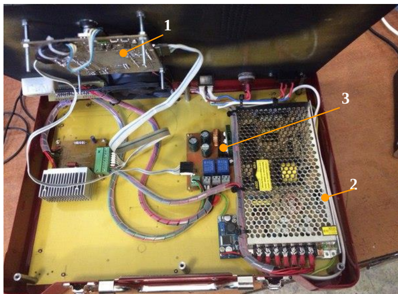
1 – блок контроллера; 2 – блок управления нагревателем; 3 – блок управления светодиодом
