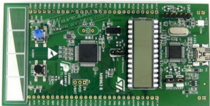
Рисунок 5.6 – Монтажная плата модуля согласования на базе микроконтроллера STM32L-Discovery
